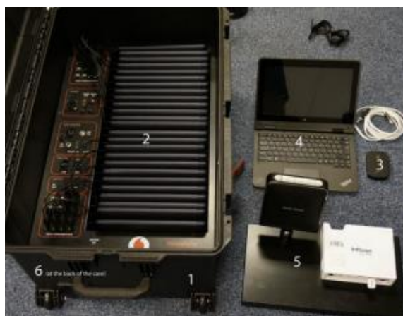
Figura 2. Cutia conține loc de depozitare tablete, încărcătoare, modem 4G cu mufă ethernet, laptop pentru cadrul didactic, proiector LED, antenă WiFi, baterii, conectivitate și butoane pentru operațiuni rapide
