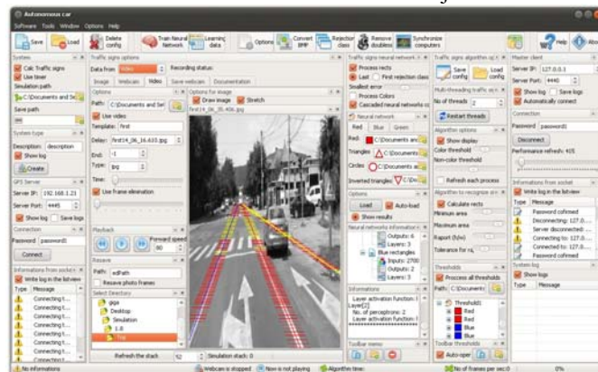
Figura 2. Această componentă software este capabilă să recunoască liniile de marcaj din imagini și să corecteze traiectoria mașinii astfel încât mașina să rămână pe banda de circulație tot timpul.
