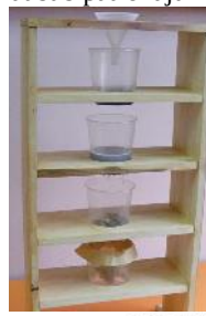
Figura 6. Miniinstalație artizanală pentru purificarea apei
