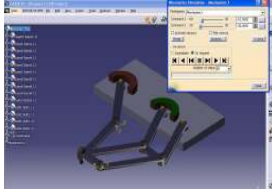
Figura 1. Modelul CAD al unui mecanism cu 5 bare articulate elaborat în CATIA
